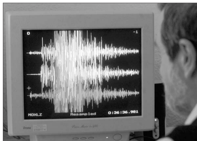
Seismogramm eines Erdbebens auf dem Monitor des Observatoriums Moxa der Uni Jena. Das Observatorium ist weltweit vernetzt.
